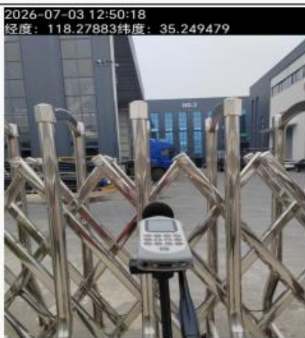
图 8 厂界噪声现场检测图
