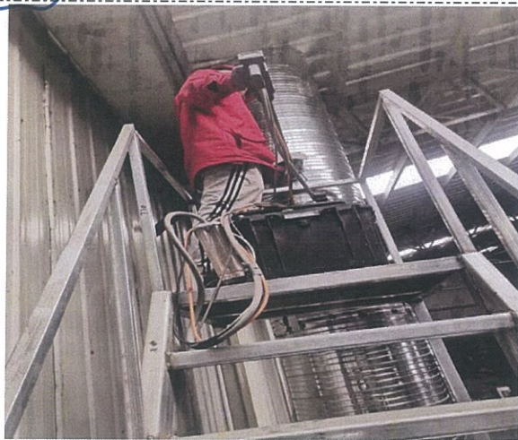
图3: 废气总排口现场采样图
