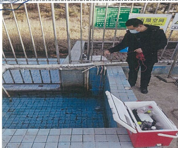
图 7: 污水处理站出口废水现场采样图
