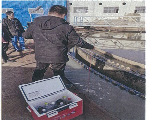
图 6: 污水处理站进口废水现场采样图
