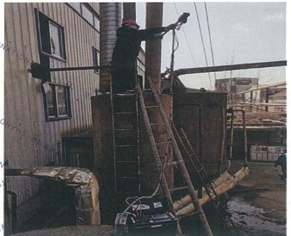
图 4: 挤出废气总排口现场采样图
