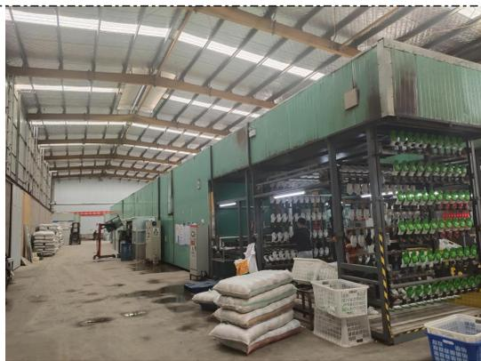
图 3-6 浸胶、烘干生产线
