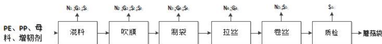
图 3.5-1 蘑菇袋制作生产工艺流程及产污环节图
