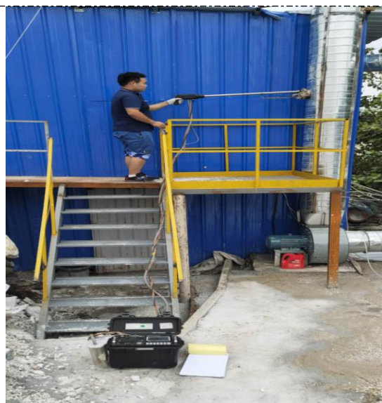
图 4-4 投料、破碎排气筒检测平台
