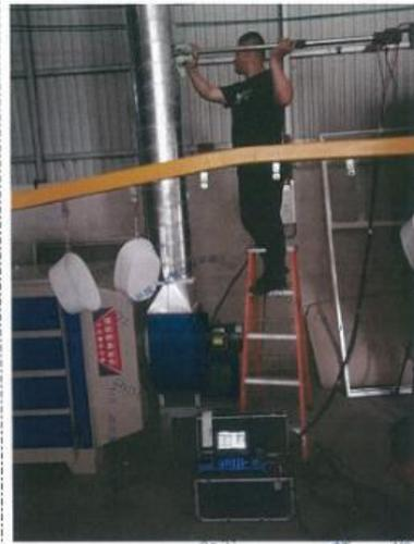
图1 固化工序出口现场采样
