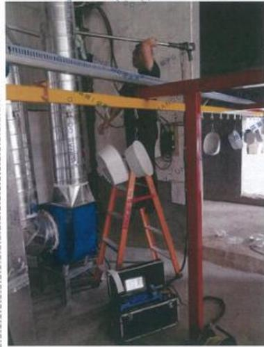
图3 喷塑工序出口现场采样
