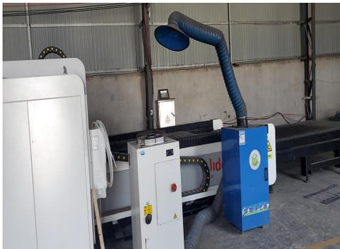
图 4-1 移动式焊烟净化器
