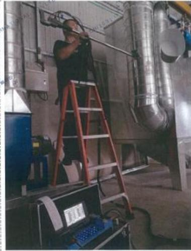
图4 喷塑工序进口现场采样
