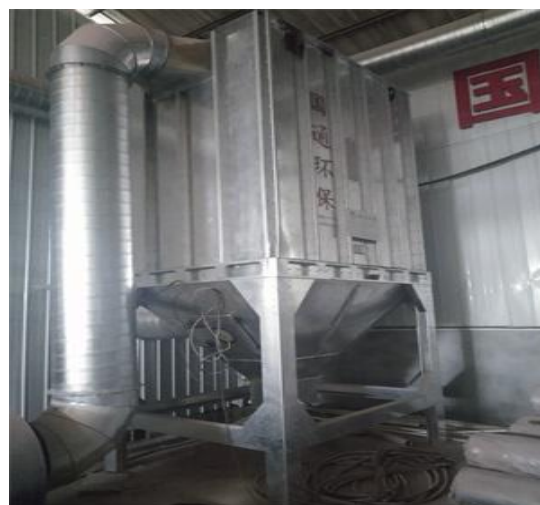
图 4-2 1#车间脉冲布袋除尘器
