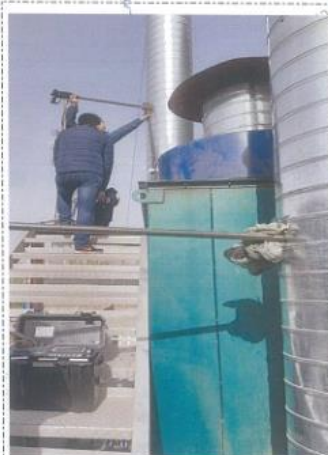
图 1 重钢切割、二保焊工序出口现场采样
