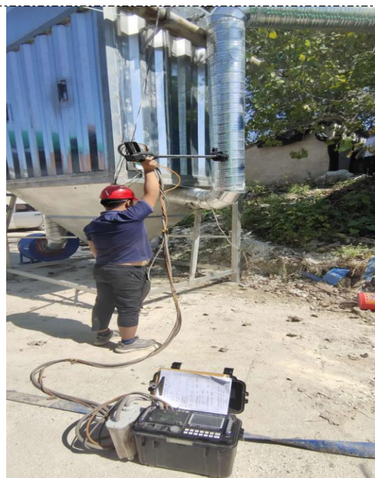
图 4-3 投料、破碎废气检测口
