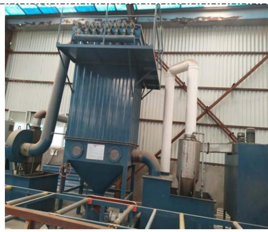
图 4-2 喷砂工序废气处理设施
