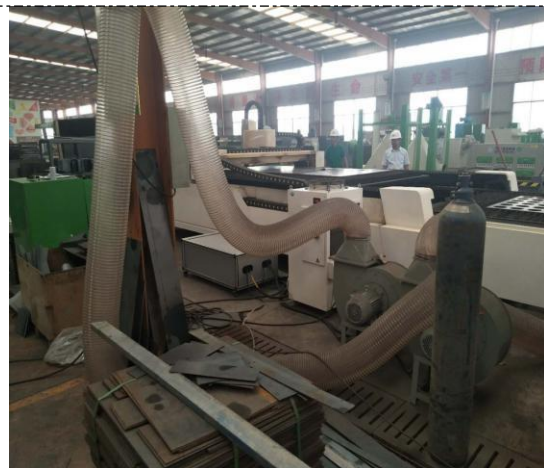
图 4-1 激光切割废气收集系统
