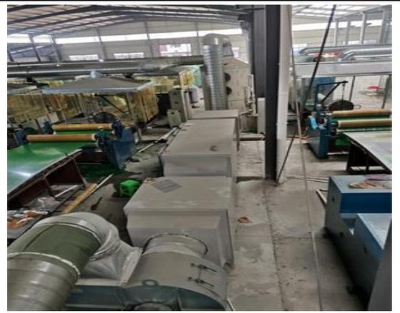
图 4-4 2#熔融挤出工序废气处理环保设施
