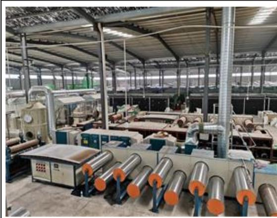
图 4-3 1#熔融挤出工序废气处理环保设施
