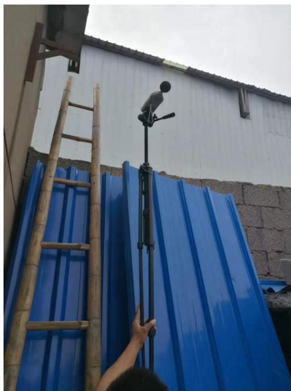
厂界噪声 3#点位现场检测图
