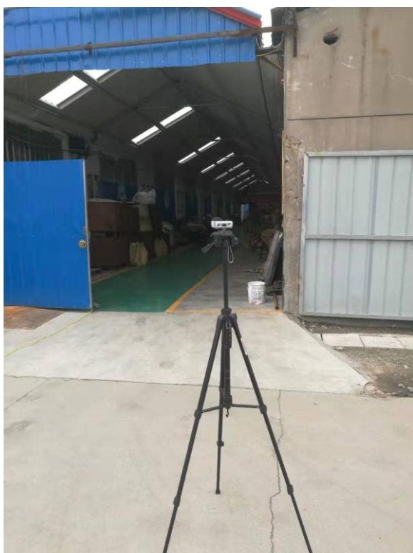
厂界噪声 1#点位现场检测图
