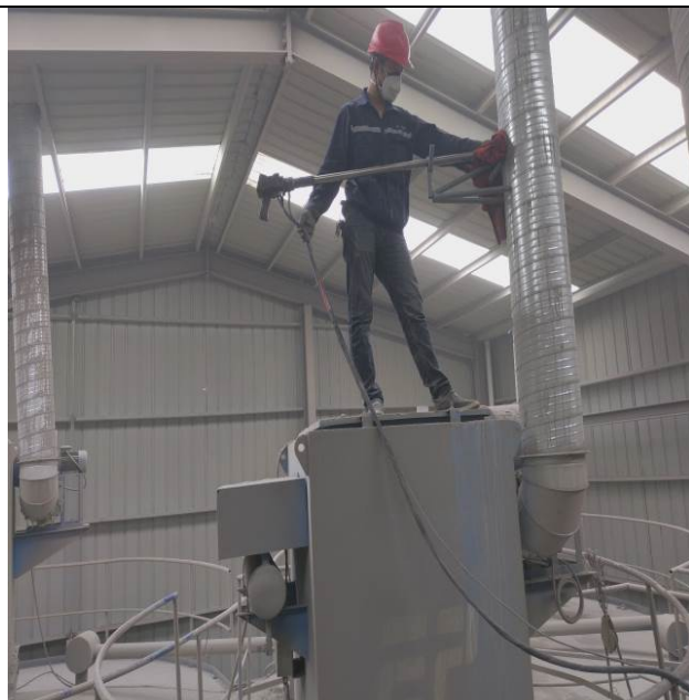
筒仓出口废气现场采样
