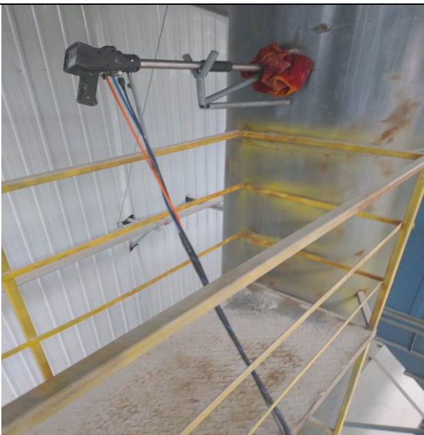
回料筛出口废气现场采样
