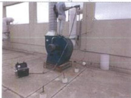
图 9: 酸雾废气出口采样图
