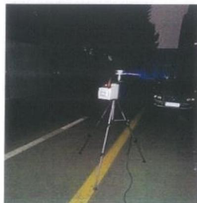
图 6: 无组织 3#点废气采样图
