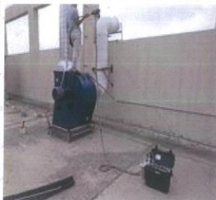
图 8: 有机废气出口采样图
