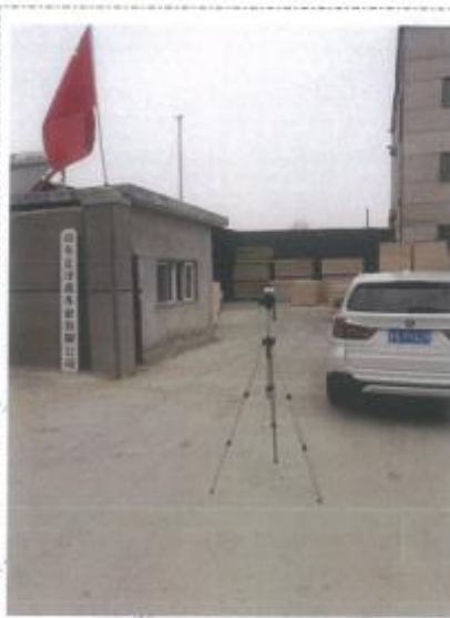
图 6 厂界 2#点位噪声现场检测
