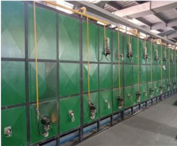
图 3-3 烧成窑炉
