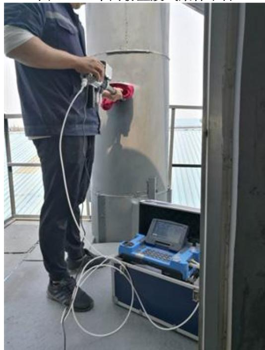
图 4-8 烧成窑废气采样平台
