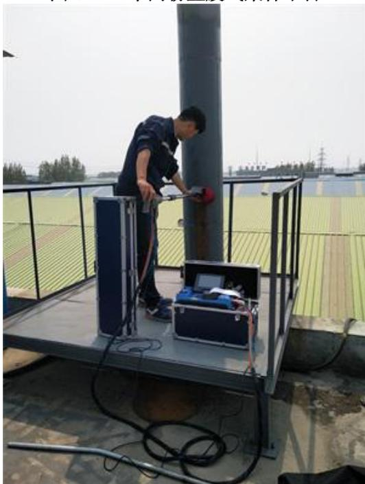
图 4-7 彩烤工序废气采样平台
