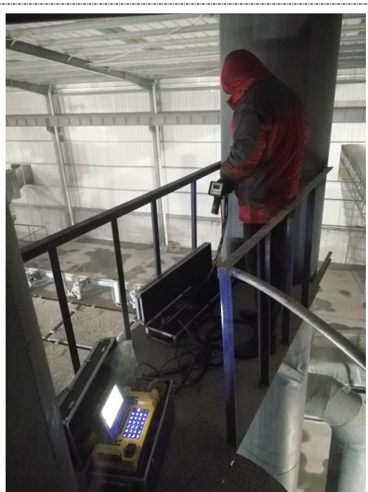
图 4-8 废气排放口采样平台
