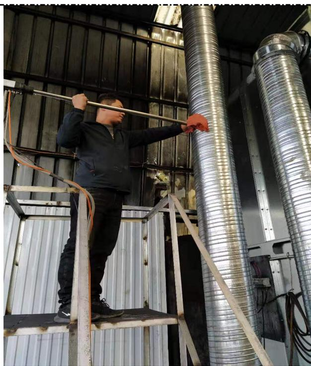
除尘器出口废气现场检测
