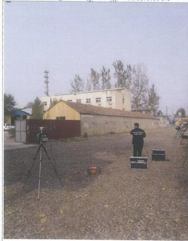
图 3: 厂界无组织废气采样图
