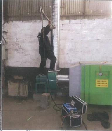
图 2: 涂胶工序出口现场采样图
