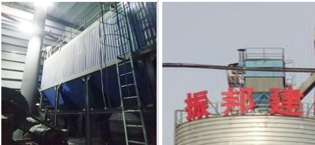
图 4-1 脉冲布袋除尘器
