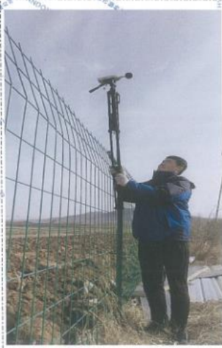
图 6 噪声 4#点位现场检测
