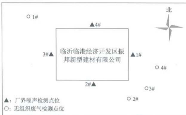
图 1-1 无组织废气、厂界噪声检测点位示意图
