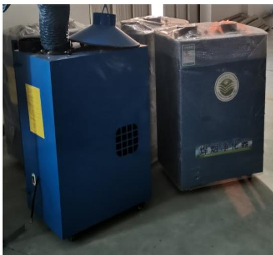
图 4-3 移动式焊接烟尘净化器
