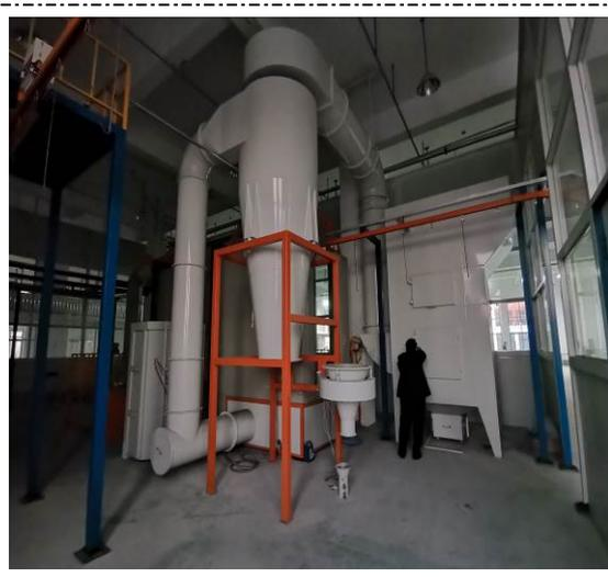
图 4-2 喷塑机自带高效除尘器
