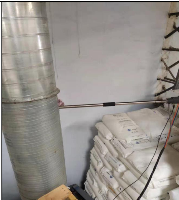
图 2：吹塑工序出口现场采样图
